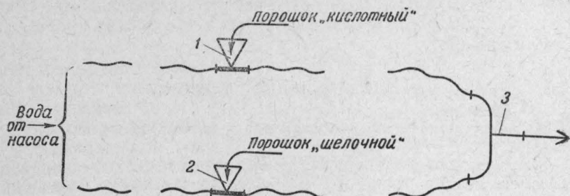
Рис. 9. Схема установки двух пеногенераторов при работе на раздельном порошке.
