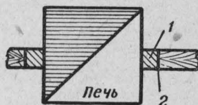
Рис. 29. Вертикальные разделки при установке печи периодического действия в проеме деревянной перегородки или стены:
